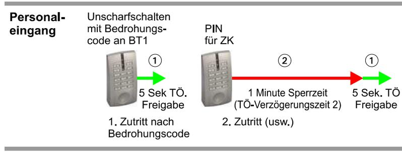
Bei einer Unscharfschaltung mittels Bedrohungscode wird der Bereich unscharf und die Tür für die auslösende PIN sofort für 5 Sek. (1) freigegeben. Danach wird die Türöffnung (Zutritt) der Personaleingangstür für nachfolgende Personen um eine Minute (2) verzögert (je Zutrittsvorgang).
