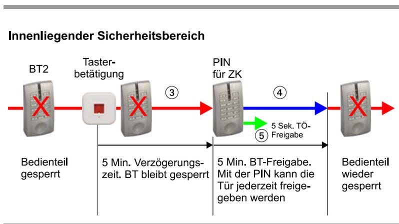
Mit der Betätigung des Tasters TA1 läuft eine Sperrzeit von 5 Minuten (3) ab. Nach Ablauf dieser Zeit werden die Code-Tastaturen zur Öffnung der Türen zu diesen Bereichen für 5 Minuten (4) freigeschaltet. Innerhalb dieser Zeit können die Türen mit einem Tür-Auf-Code für je 5 Sek. (5) geöffnet werden. Nach Ablauf dieser 5 Minuten werden die Code-Tastaturen wieder deaktiviert.
