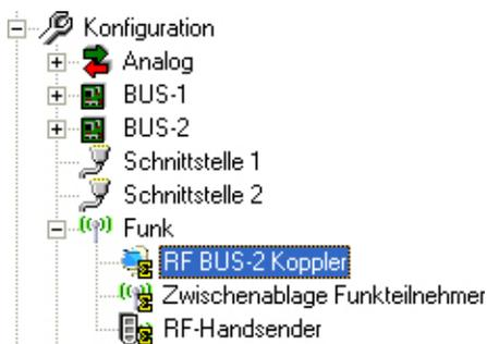
Der RF BUS-2 Koppler arbeitet als Bindeglied zwischen der leitungsgebundenen BUS-2-Technologie und der bidirektionalen Funktechnologie.
