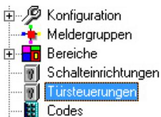
Für die Zentrale 561-MB24 und 561-MB48 können zusätzlich zu den normalen 8 bzw. 16 Schalteinrichtungen 8 Türsteuerungen angelegt werden.
