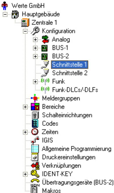
Physikalisch erfolgt die Integration eines Übertragungsgeräts DS 6600/DS 6700/DS 6750/DS 7600/DS 7700/DS 9500/DS 9600 über die seriellen Schnittstellen der Zentrale und des Übertragungsgeräts. Innerhalb von WINFEM Advanced erfolgt diese Einbindung innerhalb des Zweigs "Konfiguration".
