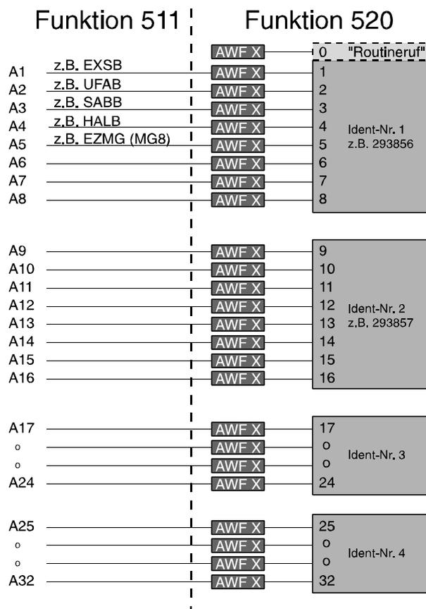
Durch Zuweisung eines der Auslösekriterien, siehe "Analogkanal", kann eine Meldung an ein Wachunternehmen etc., unter den in F:520 programmierten Bedingungen abgesetzt werden.
