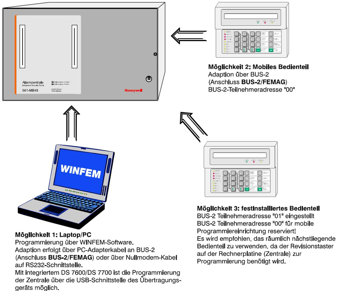
Abb. Programmiermöglichkeiten 561-MB48
