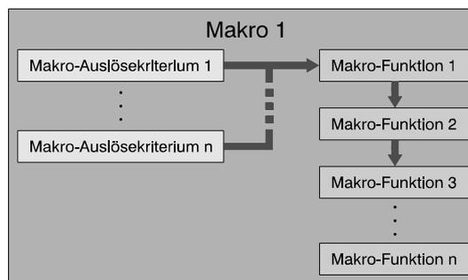
Insgesamt können bis zu 20 einzelne Makros definiert werden. Für diese 20 Makros können maximal 70 Makro-Elemente vergeben werden. Jedes Makro-Auslösekriterium sowie jede Makro-Funktion stellt hierbei ein einzelnes Makro-Element dar.
