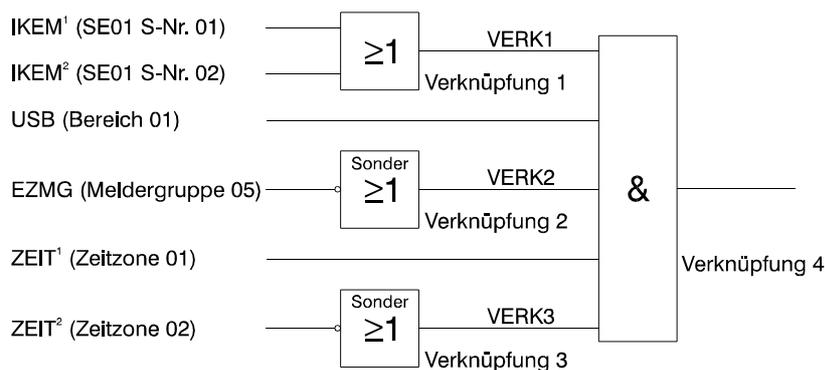
Bedeutung der Ausgangssignale:
