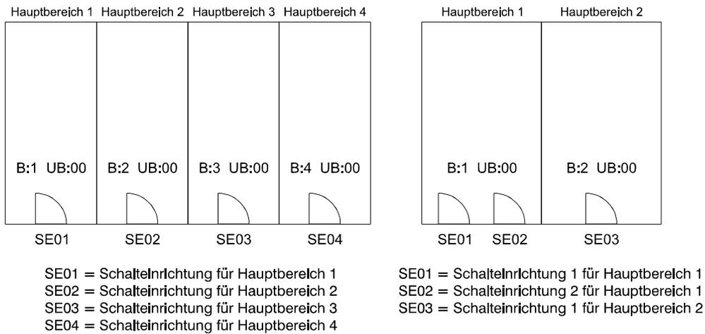
Schalteinrichtungen in Unterbereichen müssen übergeordnete Bereiche zugeordnet werden. Folgende Grafiken zeigen typische Anwendungsfälle. Abweichende Anwendungen lassen sich daraus ableiten.
