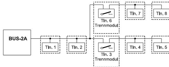
Durch die BUS-2 Analyse kann ein derartiger Installationsfehler lokalisiert und angezeigt werden. Die angezeigte Teilnehmeradresse stellt hierbei das Trennmodul mit der höherwertigen Teilnehmeradresse dar.
