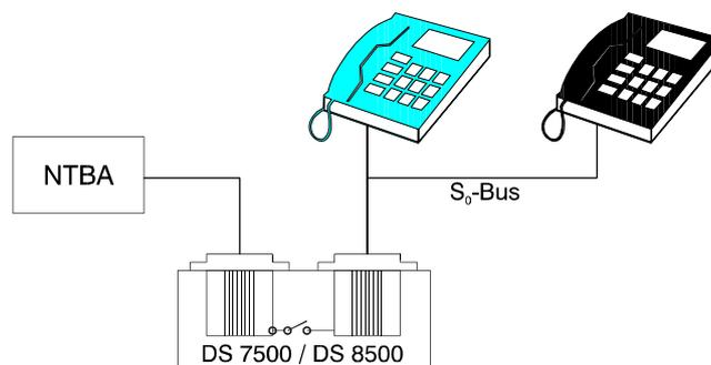
Bei dieser Anschlussvariante und entsprechender Programmierung steht das Leistungsmerkmal "Blockadefreischaltung" zur Verfügung:
