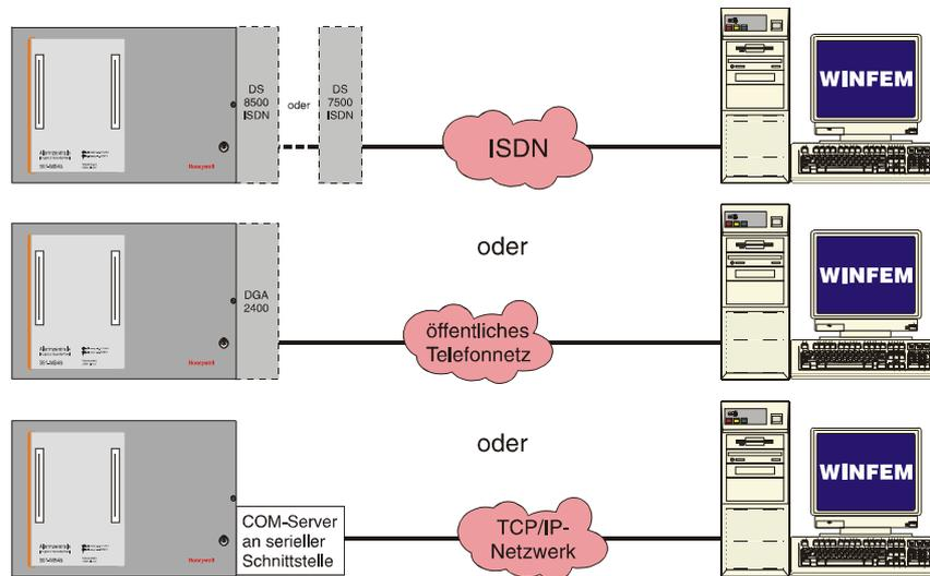
**Abb. Fernparametrierung über Fernsprechnetz bzw. TCP/IP-Netzwerk**
