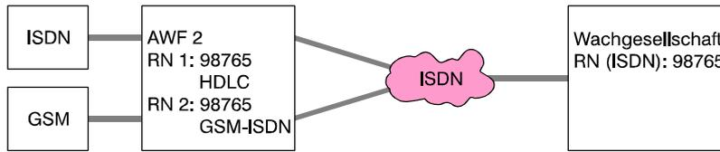
In der Anwahlfolge für den Routineruf wird zweimal die **ISDN**-Rufnummer des Wachunternehmens angegeben. Die Unterscheidung über welchen Weg der Routineruf abgesetzt wird, erfolgt durch die unterschiedlichen Empfängertypen die den Rufnummern zugewiesen wurden.
