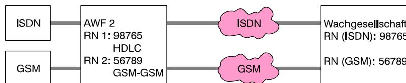
In der Anwahlfolge für den Routineruf wird die **ISDN**-Rufnummer (Empfängertyp "HDLC") sowie **GSM**-Rufnummer (Empfängertyp "GSM-GSM") des Wachunternehmens angegeben.
