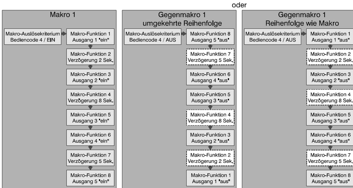
Im obigen Beispiel erfolgt die Auslösung des Makros durch Eingabe eines Bediencodes und Quittierung über Taste "EIN". Das Gegenmakro hierzu wird durch Eingabe des Bediencodes und Quittierung über "AUS" gestartet. In Abhängigkeit vom definierten Auslösekriterium stehen unterschiedliche Dynamikarten zur Auslösung des Makros sowie des Gegenmakros zur Verfügung. Siehe hierzu 3.2.1.7.
