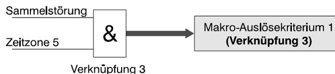
In Funktion 510 wurde eine UND-Verknüpfung mit den Ausgangssignalen "Sammelstörung" und "Zeitzone 5" definiert. Diese Verknüpfung wird dem Makro als Auslösekriterium 1 zugewiesen. Das Makro wird somit bei gleichzeitigem Anstehen beider Ausgangssignale ausgelöst.
