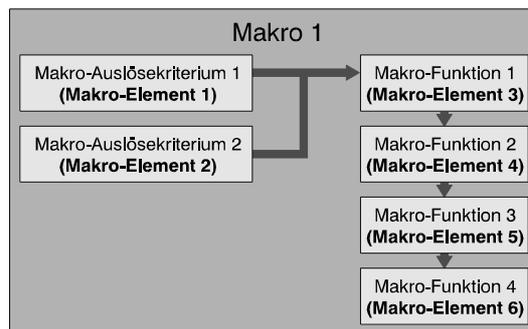
Das Beispiel-Makro besteht insgesamt aus 2 Makro-Auslösekriterien und 4 Makro-Funktionen. Dies ergibt insgesamt 6 Makro-Elemente. Für die Programmierung von weiteren Makros stehen somit 64 Makro-Elemente zur Verfügung.
