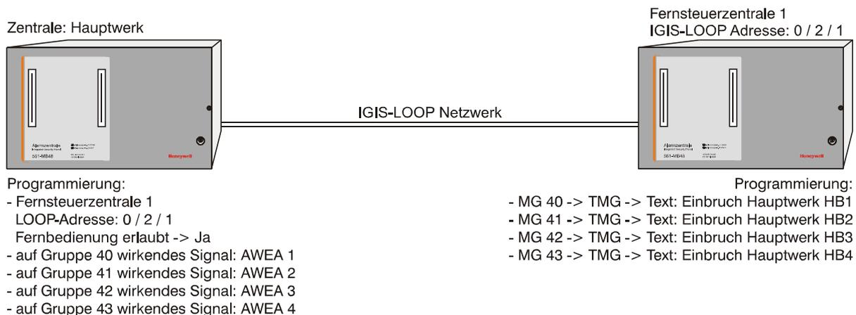
In obigem Beispiel werden Einbruchalarme der Bereiche 1, 2, 3 und 4 an der Fernsteuerzentrale 1 als Technikalarme auf den Meldergruppen 101, 102, 103 und 104 angezeigt. Technikgruppen wurden hier gewählt, damit zwar auf den Alarm in der Hauptwerk-Zentrale aufmerksam gemacht wird, jedoch an der Fernsteuerzentrale kein Alarm ausgelöst wird. Die Auslösungen der Technikgruppen können z.B. über einen Summer ausgegeben werden.
