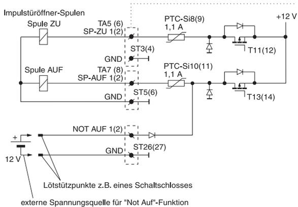
Der Eingang "NOT AUF" ermöglicht eine Notöffnung des Sperrelementes bei Totalausfall der Stromversorgung. Dazu wird der Anschluss "NOT AUF" z.B. an ein Schaltschloss geführt. Durch Anlegen einer 12 V - Spannungsquelle lässt sich die "AUF"-Spule bestromen.
