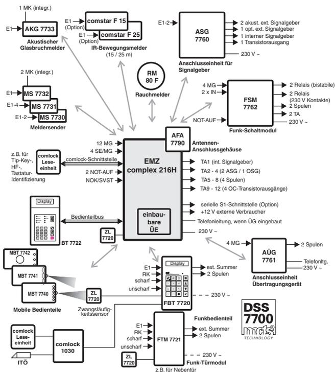
ÜE: bei VdS-Anlagen ist immer eine Übertragungseinrichtung erforderlich
