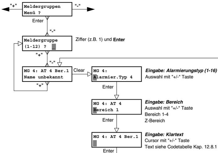
Die EMZ complex 216H hat 12 per Draht anschließbare Meldergruppen. Diesen Meldergruppen können ebenso wie den Funkkomponenten ein Alarmierungstyp zugeordnet werden.
