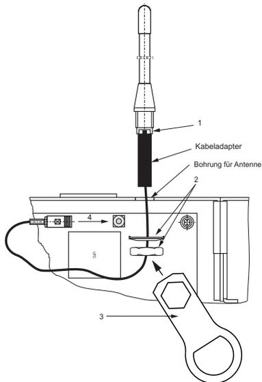
**ACHTUNG:** Am unteren Ende der Antenne befindet sich ein fest montierter Kabeladapter (kleine Platine im Schrumpfschlauch) mit Leitung und Koaxstecker. Bei den Montagearbeiten ist besonders darauf zu achten, dass diese Einheit nicht beschädigt, gebogen oder geknickt wird.
