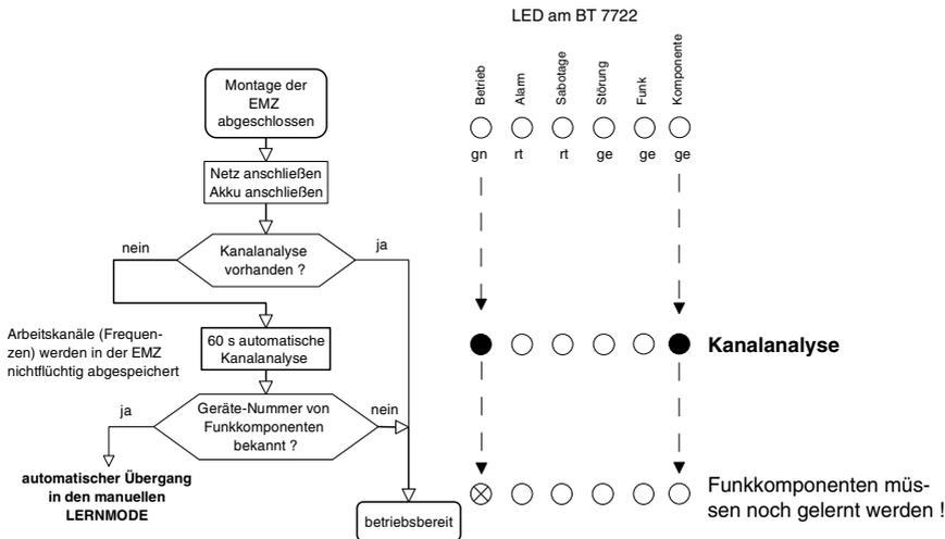
**Neue Kanalanalyse einleiten** (Kanalanalyse von einem anderen Montageort vorhanden):
