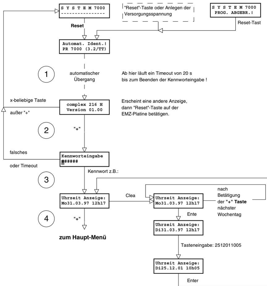
1. Nach Einstecken der Programmiereinheit PR 7000 in die Buchse BU3 auf der EMZ-Platine (bei gedrückter Reset-Taste) können die Parameter der EMZ parametrierbar werden.
