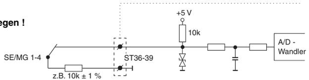
**Bei Verwendung als Schalteinrichtungseingang (SE)** können Funktionen, die zugehörigen Bereiche und Abschlusswiderstände zugeordnet werden (siehe Kap. 12.7).
