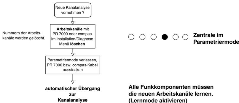
**HINWEIS:** Die Gehäusedeckel der Funkkomponenten erst schließen, wenn das System vollständig betriebsbereit ist (Kanalanalyse durchgeführt, Geräte-Nummern gelernt, Parametrierung abgeschlossen und übertragen).
