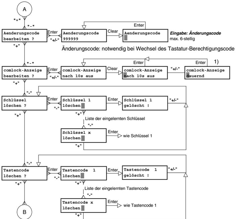
**ACHTUNG:** Nach dem Löschen eines Schlüssels bzw. eines Tastencode werden die nachfolgenden Schlüssel bzw. Tastencode neu sortiert.
