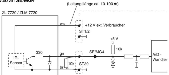
**HINWEIS:** Die Meldergruppe **muss** parallel zum ZL-Sensor mit einem 10 kOhm Widerstand abgeschlossen werden.
