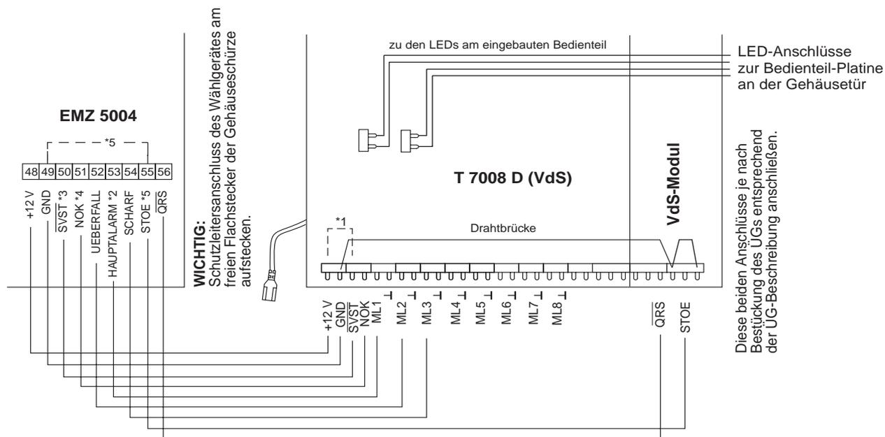
\*1 Sollen die Netzteilstörsignale unbeachtet bleiben, so muss die Verbindung "SVST" aufgetrennt und der Anschluss "SVST" auf +12 V gebrückt werden.
