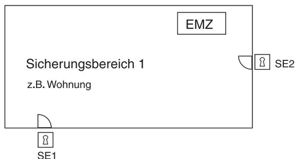
Die externe Scharfschaltung eines Sicherungsbereiches erfolgt erst dann, wenn alle Schalteinrichtungen (SE1, SE2) betätigt wurden. Die Unscharfschaltung erfolgt bereits nach Betätigung einer Schalteinrichtung.
