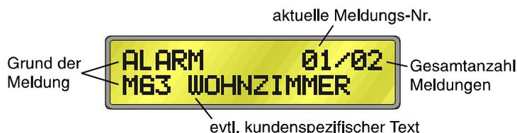
5. Sollten mehrere Meldungen vorliegen (siehe "Gesamtzahl Meldungen") kann über Taste "F1" zwischen den einzelnen Meldungen gewechselt werden. Die Auflistung der "Alarm"-Meldungen erfolgt hierbei in chronologischer Reihenfolge. Das heißt, die Meldergruppen werden in der Reihenfolge angezeigt, in der auch die Auslösung erfolgte.
