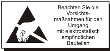
**ACHTUNG: Die Platinen enthalten CMOS-Elemente, die durch statische Entladung beschädigt werden können. Daher müssen bei dem Umgang mit Platinen geeignete Vorsichtsmaßnahmen getroffen werden.**
