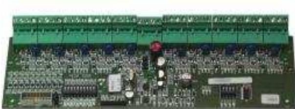
**Überwachungsmodul mit 10 Eingängen für den Notifier - Ringbus**
