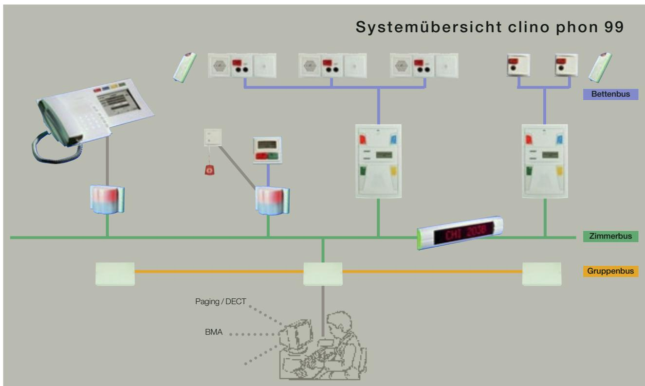
Die Infrastruktur von clino phon 99 baut auf der bewährten Bus-Struktur des Systems clino opt 99 auf. Als Steuereinheit für den Gruppenbus dient die Gruppenzentrale. Durch den dezentralen Aufbau ist dieses System besonders für die schrittweise Sanierung von Altbauten im laufenden Betrieb geeignet. Innerhalb einer Station bilden die neuen Zimmerterminals oder gegebenenfalls Elektronikmodule die Steuereinheit für ein Zimmer.
