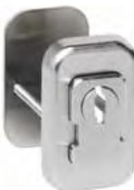
Sicherheits-Rosette mit Kernziehschutz für Profilhalbzylinder. Mit 12 mm starkem Außenschild für Zylinderüberstand von 9 - 14 mm.
