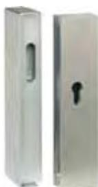
Bestehend aus Blockschloss- und Schließblechaufnahmeteil mit 40 mm starkem, massivem Eisen für aufgesetzte Montage zum Anschweißen an Tresor- und Metalltüren, passend für Blockschlösser mit Profilhalbzylinder, inkl. Sonderstulp.
