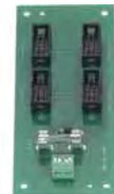
Anschlussadapter externe Stromversorgung für IGIS-LOOP LED-Tableau.
