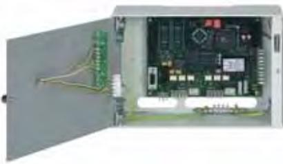
Im Gehäuse ZG0. Gehäuse mit Schwenktür. Verschluss über Verplombung.
