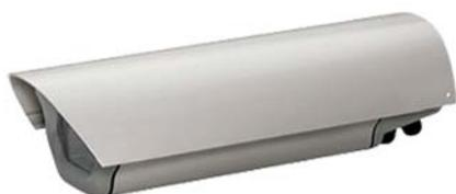
Wetterschutzgehäuse für den Außenbereich mit thermostatisch geregelter 12 V DC / 24 V AC Heizung und Sonnendach zum Einbau von CCD-Kameras; hochwertiges, eloxiertes Aluminium lackiert; servicefreundliche Handhabung. Für das Gehäuse gibt es zwei Montagevarianten, einmal mit Wandhalterung AVH500CMB für die verdeckte Kabeleinführung durch den Halter oder mit Standard Wandhalter AVH500WMB. Die Kabeleinführung erfolgt über die drei MG Verschraubungen.
