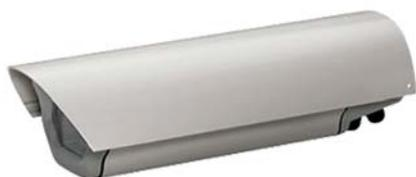
Wetterschutzgehäuse für den Außenbereich mit thermostatisch geregelter 230 V AC Heizung und Sonnendach zum Einbau von CCD-Kameras; hochwertiges, eloxiertes Aluminium lackiert; servicefreundliche Handhabung durch klappbares Gehäuseoberteil. Für das Gehäuse gibt es zwei Montagevarianten, einmal mit Wandhalterung AVH500CMB für die verdeckte Kabeleinführung durch den Halter oder mit Standard Wandhalter AVH500WMB. Die Kabeleinführung erfolgt über die drei MG Verschraubungen.
