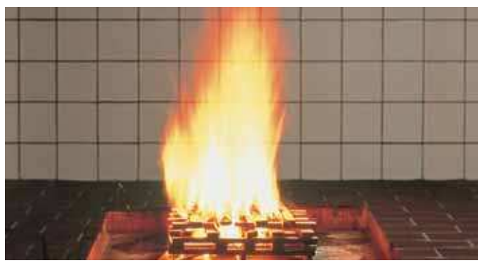
Testfeuer 1: offener Zellulosebrand (Holz)
