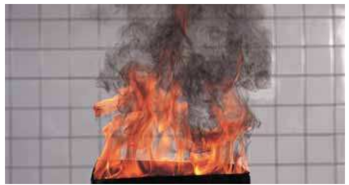
Testfeuer 5: Flüssigkeitsbrand (n-Heptan)
