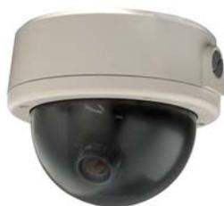
Vandalismusgeschützte IP Dome Kameras mit hochauflösendem Kamera/Objektiv-Modul für den Deckenaufbau. Wettergeschütztes, versiegeltes Gehäuse mit Heizung für den Einsatz im Außenbereich. 180° Kameraausrichtung. Integrierte TCP/IP Option ermöglicht den Direktanschluss an ein IP Netzwerk. 24 V/AC oder PoE.
