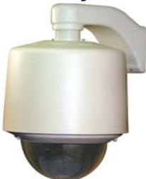
Tag/Nacht Fix Dome Kamera im gleichen Surveyor Gehäuse wie Außen PTZ Modelle, 3,3-12 mm Varioobjektiv, klare Kuppel und 24 V/AC Netzteil. Integriertes ViconNet® TCP/IP Videoübertragungsmodul für Direktanschluss an ein IP Netzwerk.
