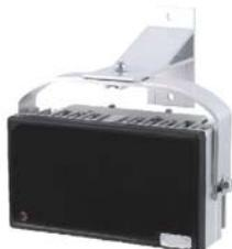
Die LED Strahler ermöglichen die semidiskrete Ausleuchtung eines Überwachungsbereiches mit Infrarotlicht, wobei das IR-Licht über einen integrierten Dämmerungsschalter automatisch geregelt werden kann. Das integrierte Netzteil erfordert eine 230 V/AC Spannungsversorgung.
