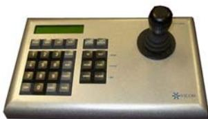
**V1411J-DVC 6695-01** Tastatur mit 3-Achsen Joystick zur Steuerung und Programmierung der Vicon Kreuzschienen, kompatibel zu Vicon Surveyor VFT Dome Systemen.
