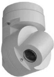
**VKK-50/2,9 555429** 1/3" S/W-Kompaktkamera, 570 TV-Linien, 0,01 Lux, inkl. 2,9 mm Objektiv und Netzteil-/Anschaltplatine, IP 65, Linelock, 12 V/DC / 230 V/AC.
