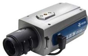
1/3" WDR Tag/Nacht Kamera, 650 TV-Linien, 0,4 Lux (Farbe)/0,04 Lux (SW) bei F1,2 (50 IRE), 3D Digitale Rauschunterdrückung, Gegenlichtkompensation, EHLC Funktion (Excessive High Light Compensation), Privatzenen, Motion Detection und weitere Videoanalyse-Funktionen, On Screen Menü, Bildratensteuerung.
