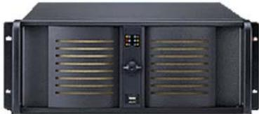
**VN-NUC 10050** ViconNet® Nukleus, vollständig konfigurierter PC (19" einbaufähig) mit ViconNet Workstation Software, empfohlen für den Einsatz in Verbindung mit mehreren (>5) Kollektor Strike und Force Hybridrekordern, NVRs bzw. IP Kameras zur Verwaltung der Teilnehmer, Netzwerkadressen und Kennwörter (Domain Server)
