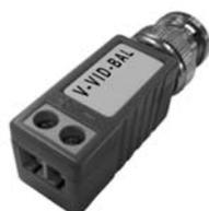
**V-VID-BAL 6518-20** Passiver Video-Zweidrahtsender/-Empfänger, sendet oder empfängt Videosignale über Zweidrahtstrecken mit Distanzen bis zu 400 m (Farbe) (bei beidseitigem Einsatz des V-VID-BAL) bzw. mit größeren Distanzen in Verbindung mit allen aktiven Vicon Empfängern.
