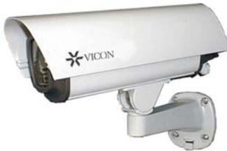
**FA-661N/3-8HR 9925-13** 1/3" Tag/Nacht Komplettkamera für den Außeneinsatz mit 600 TV-Linien, 0,1 Lux (Farbe) / 0,04 Lux (SW) bei F1,2, inkl. 3,0-8mm/ F1,0DC/IR/HR Vario-Objektiv inkl. Objektiv-einmessung, eingebaut in das ALU-2500/12 Wetterschutzgehäuse (IP 67) inkl. Netzteil, Heizung, Montagehalterung und Sonnenschutzdach, 230 V/AC.
