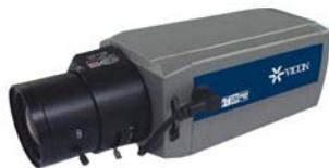
1/3" Tag/Nacht Kamera mit digitalem WDR, 600 TV-Linien, 0,1 Lux (Farbe) / 0,04 Lux (SW) bei F1,2, 2D Digitale Rauschunterdrückung, Gegenlichtkompensation, HLC Funktion (High Light Compensation), Privatzenen, Motion Detection, On Screen Menü.
