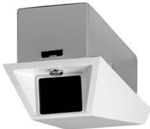
Das kompakte, manipulationssichere V8612H Gehäuse für den Deckeneinbau bietet eine Möglichkeit, kleinere Kameras diskret zu positionieren. Das Gehäuse ist eine in sich komplett geschlossene Einheit, und bietet maximalen Schutz vor Eindringen von Staubpartikeln. Das klappbare Unterteil ist mit einer manipulationssicheren Sperrvorrichtung ausgestattet.
