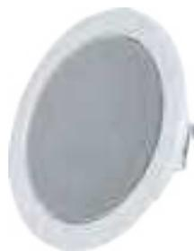
Der Metall Bajonettdeckeneinbaulautsprecher mit einem 165 mm Breitbandlautsprecher Chassis und einem hohen Wirkungsgrad bietet einen hervorragenden Klang für alle Einsatzbereiche. Federschnappverschlüsse mit gekröpfter Schenkelfeder, verstärkter Klemmkraft und kürzerem Spannweg ermöglichen eine schnelle und unkomplizierte Montage. Somit ist ein bündiger Einbau in abgehängten Decken möglich.
