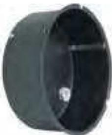
Feuertopf (EF 165) für Deckenlautsprecher (Art.-Nr. 581254) zur Erhöhung der passiven Sicherheit. Der Feuertopf verhindert die Sogwirkung des Kamineffektes bei abgehängten Decken im Brandfall, nach etwaigem Durchbrennen der Lautsprechermembrane.
