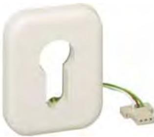
Rosette mit kombinierter Sende- und Empfangsantenne. Ein Abschirmblech auf der Rückseite vermindert die störenden Einflüsse des Untergrundes. Zum Anschluss an das Blockschloss dient ein Flachkabel mit Stecker.
