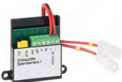
Für die Funktionskontrolle des Sperrelements und Hilfe zur exakten Positionierung des Bolzen-Gegenstücks.
