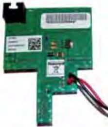
Das Ethernet-Einsteckmodul dient zur Erweiterung der Domonial-Funk-Einbruchmelderzentrale. Das Modul kann als redundanter Übertragungsweg, oder als Hauptübertragungsweg dienen, falls kein drahtgebundener Fernsprechanschluss vorhanden ist. Das Modul wird direkt an einen ADSL Router oder einen Hub angeschlossen.
