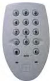
Festmontiertes Bedienteil für den Innenbereich mit numerischer Tastatur und berührungslosem Leser. Das Bedienteil kann bis zu 10 Benutzercodes verwalten und dient zur Scharf-/Unscharfschaltung, sowie zur Übermittlung von sonstigen Schaltbefehlen über Funk. Bei entsprechender Programmierung kann das Bedienteil auch zur Auslösung eines Überfallalarms benutzt werden. Eine integrierte Leseinheit ermöglicht zusätzlich die Benutzeridentifikation durch Identdatenträger (Transponder).
