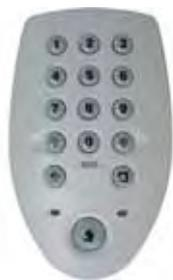
Festmontiertes Bedienteil für den Innenbereich mit numerischer Tastatur. Das Bedienteil kann bis zu 10 Benutzercodes verwalten und dient zur Scharf-/Unscharfschaltung, sowie zur Übermittlung von sonstigen Schaltbefehlen über Funk. Bei entsprechender Programmierung kann das Bedienteil auch zur Auslösung eines Überfallalarms benutzt werden.
