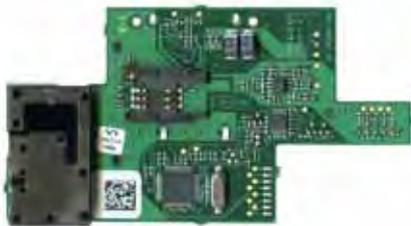
Das GSM/GPRS Einsteckmodul dient zur Erweiterung der Funk-Einbruchmelderzentrale CMI800 AWUG.
