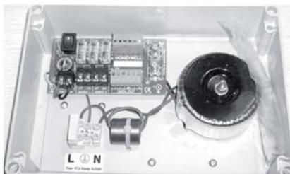
Netzteil, 230 / 24 V AC, 5 A (75 VA), 1x 1-A-, 1x 4-A-Ausgänge für Außen-Dome-Kameras und Heizung, Spannungsanzeige, Ein-/Aus-Schalter, Sicherungen, Daten, BNC-Ein- und -Ausgang, Blitzschutz, 20-, 25-, 32-, 40-mm-vorgestanzte Kabeleinführungen.
