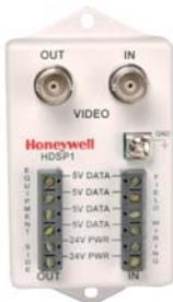
Die kompakte Überspannungseinheit HDSP1 sichert eine Videoleitung und eine Niedervolt Spannungsversorgung bis zu 24 V AC / DC gegen kurzzeitig auftretende Spannungsspitzen ab. Zusätzlich können 4 Datenleitungen 5 Volt (RS422-RS485) gegen Überspannung abgesichert werden. Der Anschluss der Datenleitungen erfolgt durch Schraubklemmen.
