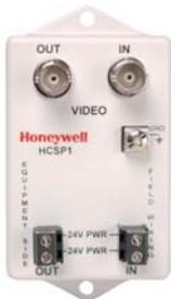
Die kompakte Überspannungseinheit HCSP1 sichert eine Videoleitung und eine Niedervolt Spannungsversorgung bis zu 24 V AC / DC gegen kurzzeitig auftretende Spannungsspitzen ab. Für die Durchschleifung des Videosignals stehen 2 BNC Buchsen zur Verfügung.
