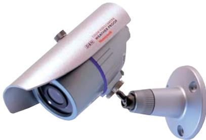
Farb-/SW-Stiftkamera, 1/3", außen, 12IR LEDs, 380 TVL, 0,1 Lux, 4,3mm, 12 V DC.
