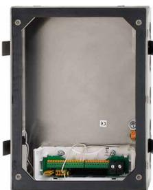
Vandalensicherer Einbaukasten für das Zellenterminal ZT99 protect. Ausführung inklusive Dichtgummi um die Schutzart IP 54 zu gewährleisten. Putzbündiger Einbau mit Spezialschrauben zur Sicherung gegen Sabotage durch Dritte. Ausgestattet mit Kabeleinführungen für die Zuleitung der notwendigen Verkabelung.
