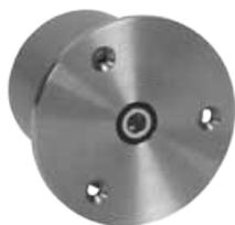
Sensortaster als Abstelltaster mit LED-Findelicht und Beruhigungslampe grün und 4-mm-Messingfrontplatte, glanzverchromt, ø 70 mm und 3 Innensechskantschrauben als Frontplattenbefestigung.
