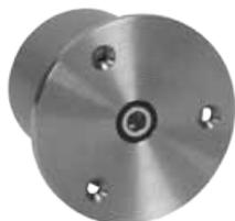
Sensortaster als Ruftaster mit LED-Findelicht und Beruhigungslampe - rot - und 4-mm-Messingfrontplatte, glanzverchromt, ø 70 mm und 3 Innensechskantschrauben als Frontplattenbefestigung.
