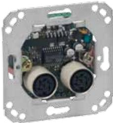
Wie 73075B, jedoch mit 2 Steckkontakten (6-polig) sowie ohne Ruftaster. Anschluss von 2 medizinischen Einheiten (z. B. Infusiomat) mit Alarmkontakt möglich.
