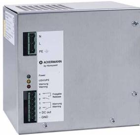
Gerätekombination aus Einphasen-Netzgerät (0,8 A) für die konstante Gleichstromversorgung sowie als unterbrechungsfreie Stromversorgung (Online DC-USV) von selektiven Einheiten des Patienten-Ruf-Systems. Kompakte Bauweise durch moderne primär getaktete Schaltungstechnik mit integriertem Batteriemodul, vorbereitet zur Hutschienenmontage in der Unterverteilung. Der Ausgang des Netzgerätes ist leerlauf-, überlast- und kurzschlussfest.
