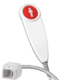
Birntaster in ergonomischer Gehäuseausführung (IP 67) mit antimikrobieller Oberfläche, Anschlussstecker selbstlösend A-kodiert mit einer Anschlussleitung von 2,5 m. Leicht bedienbare Ruftaste mit integriertem Findelicht. Ruftaste Ausführung in Ruhestrom.
