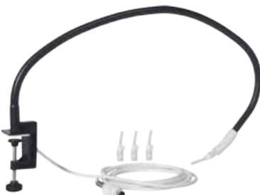
Pneumatische Atem-Rufeinheit mit 7-poligem Stecker zum Einsatz für bewegungsunfähige Patienten. Die Einheit wird über einen 7-poligen Nebensteckkontakt mit dem Patienten-Rufsystem verbunden. Die Rufauflösung erfolgt pneumatisch durch kräftiges Hineinatmen.
