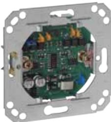
Bus-Weiche/-Repeater ermöglicht die Verzweigung am Zimmerbus und kann als Verstärker für diesen eingesetzt werden.
