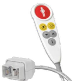
Mehrfachtaster in ergonomischer Gehäuseausführung (IP 67) mit antimikrobieller Oberfläche, Anschlussstecker selbstlösend mit einer Anschlussleitung von 2,5 m. Leicht bedienbare Ruftaste mit integriertem Findelicht , 2 Lichttasten sowie 3 weiteren Funktionstasten. Ruftaste Ausführung in Ruhestrom.
