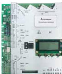
Wie 72660A, jedoch maximal 4 Gruppenzentralen vernetzbar. Pro Gruppenzentrale werden max. 50 aktive Einheiten am Zimmerbus unterstützt.
