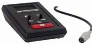
Schallwächter mit regelbarer Geräuschschwelle und Rufauflösezeit, Mikrofon, Ruftaste (rot) und Taste für Rufsperrung zum Testen der Geräuschschwelle, 2 LED-Kontrolleuchten, 2-m-Anschlussleitung mit 7-poligem DIN-Stecker.
