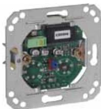
Abstellmodul mit individueller Ortskennung zum Anschluss an ein Elektronikmodul oder Zimmerterminal mit Bettenbus. Über die externe Rufeinheit wie den „Ruftaster mit Zugschnur und Knäuf“ oder auch die „Rufeinheit mit Ruftaster mit 1 Steckkontakt“ ausgelöste Rufe werden lokal über die Abstelltaste quittiert. Anschluss von bis zu 8 aktiven Modulen in adernsparender Technik an den Bettenbus möglich. Anzeige der Kennung (bis zu 8-stellig, frei konfigurierbar) bei Rufauslösung.
