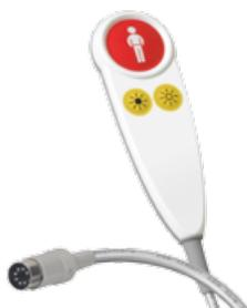
Mehrfachtaster in ergonomischer Gehäuseausführung (IP 67) mit antimikrobieller Oberfläche, Anschlussstecker 7-polig mit einer Anschlussleitung von 2,5 m. Leicht bedienbare Ruftaste mit integriertem Findelicht sowie 2 Lichttasten. Ruftaste Ausführung in Ruhestrom.
