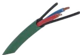
Systemkabel für den Stationsbus als 4-adriges, halogenfreies Systemkabel für die 24 V-DC-Spannungsversorgung (2 x Kupfer-Litzenleiter) und die Daten- und Sprachübertragung (2 x LWL POF).
