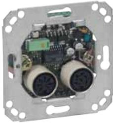
Rufeinheit zur Rufauslösung zum Anschluss an ein Elektronikmodul oder Zimmerterminal über einen passiven Eingang. Bewegliche Rufeinheiten wie Birn- und Mehrfachtaster werden an den Steckkontakten (7-polig) angeschlossen. Zusätzlicher Steckkontakt (6-polig) zum Anschluss einer medizinischen Einheit (z. B. Infusiomat) mit Alarmkontakt.
