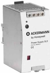
Einphasen-Netzgerät (5 A) für die konstante Gleichstromversorgung der Rufanlage. Kompakte Bauweise durch moderne primärgetaktete Schaltungstechnik, geeignet zur Hutschienenmontage in der Unterverteilung. Mit Hilfe des Montagekits (Sicherheitsabdeckung) 89954MA ist auch die Wandmontage außerhalb der Unterverteilung möglich. Der Ausgang des Netzgerätes ist leerlauf-, überlast- und kurzschlussfest.
