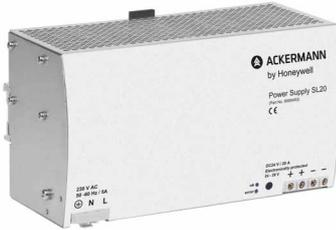
Einphasen-Netzgerät (20 A) für die konstante Gleichstromversorgung der Rufanlage. Kompakte Bauweise durch moderne primärgetaktete Schaltungstechnik (gem. EN6100-3-2), geeignet zur Hutschiennenmontage in der Unterverteilung. Mit Hilfe des Montagekits (Sicherheitsabdeckung) 89954MC ist auch die Wandmontage außerhalb der Unterverteilung möglich. Der Ausgang des Netzgerätes ist leerlauf-, überlast- und kurzschlussfest.
