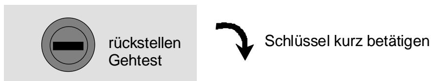
Abb. 6: Rücksetzen der akustischen Signalgeber
