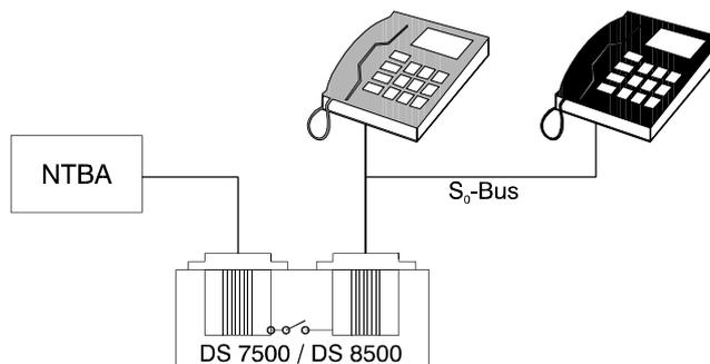
Bei dieser Anschlußvariante und entsprechender Programmierung steht das Leistungsmerkmal "Blockadefreischaltung" zur Verfügung:
