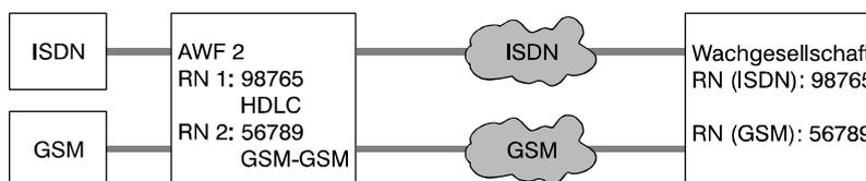
In der Anwahlfolge für den Routineruf wird die **ISDN**-Rufnummer (Empfängertyp "HDLC") sowie **GSM**-Rufnummer (Empfängertyp "GSM-GSM") des Wachunternehmens angegeben.
