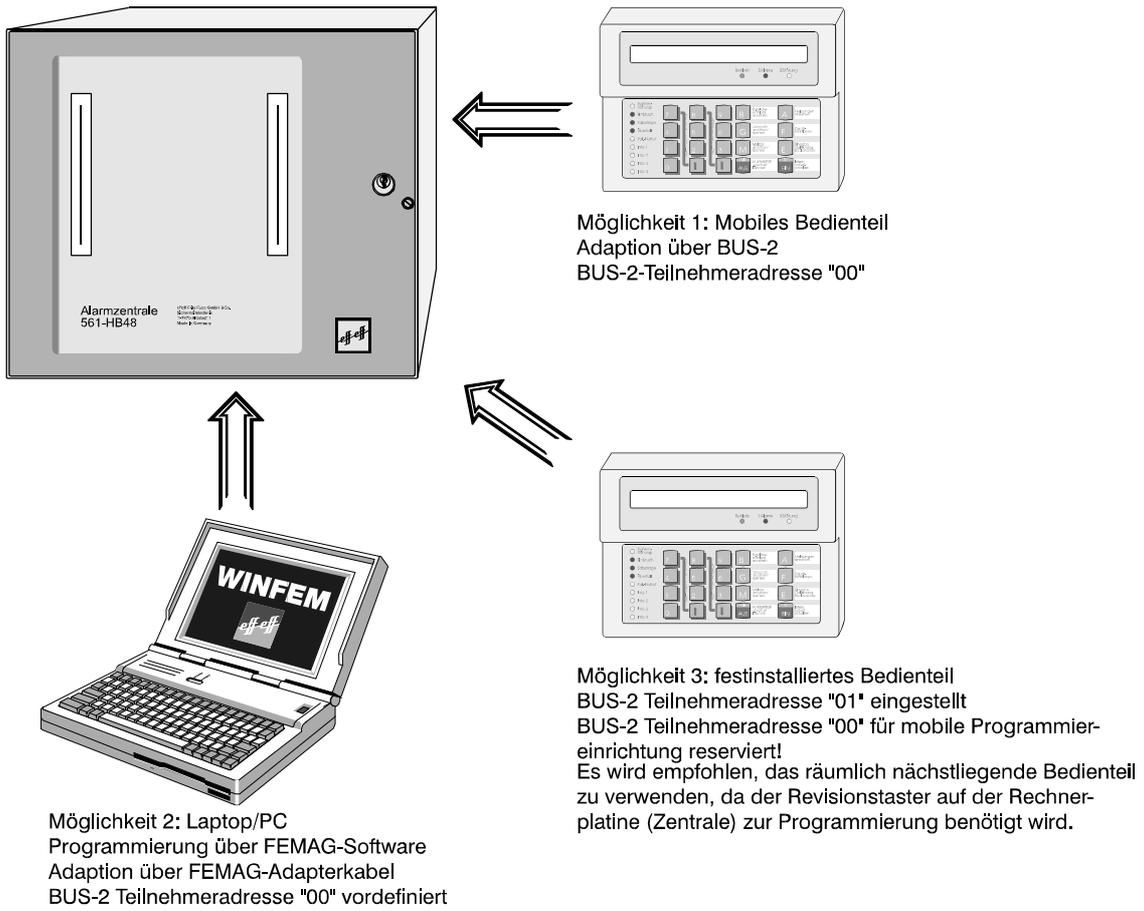
Abb. 18 Programmiermöglichkeiten 561-HB48
