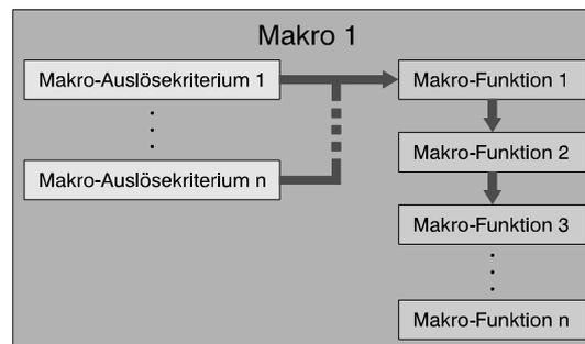
Insgesamt können bis zu 20 einzelne Makros definiert werden. Für diese 20 Makros können maximal 70 Makro-Elemente vergeben werden. Jedes Makro-Auslösekriterium sowie jede Makro-Funktion stellt hierbei ein einzelnes Makro-Element dar.
