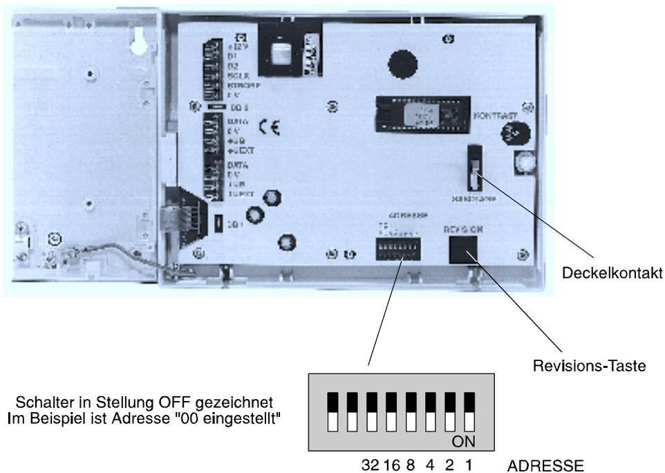
Abb. 19 BUS-2 Bedienteil geöffnet
