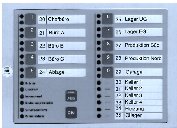
Abb. 189 Code-Ziffernbelegung auf den Sperrtasten
