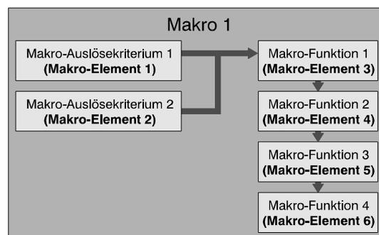
Das Beispiel-Makro besteht insgesamt aus 2 Makro-Auslösekriterien und 4 Makro-Funktionen. Dies ergibt insgesamt 6 Makro-Elemente. Für die Programmierung von weiteren Makros stehen somit 64 Makro-Elemente zur Verfügung.
