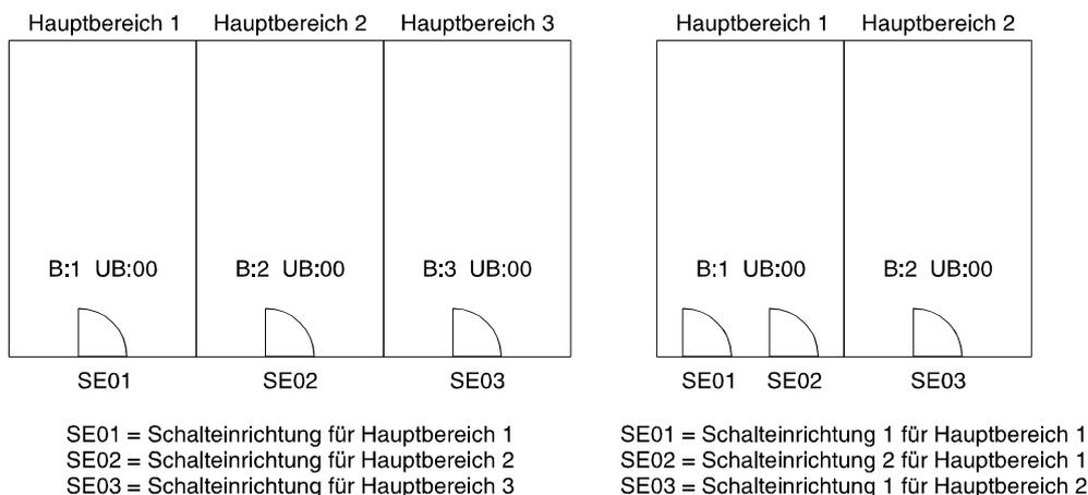
Schalteinrichtungen in Unterbereichen müssen übergeordnete Bereiche zugeordnet werden. Folgende Grafiken zeigen typische Anwendungsfälle. Abweichende Anwendungen lassen sich daraus ableiten.
