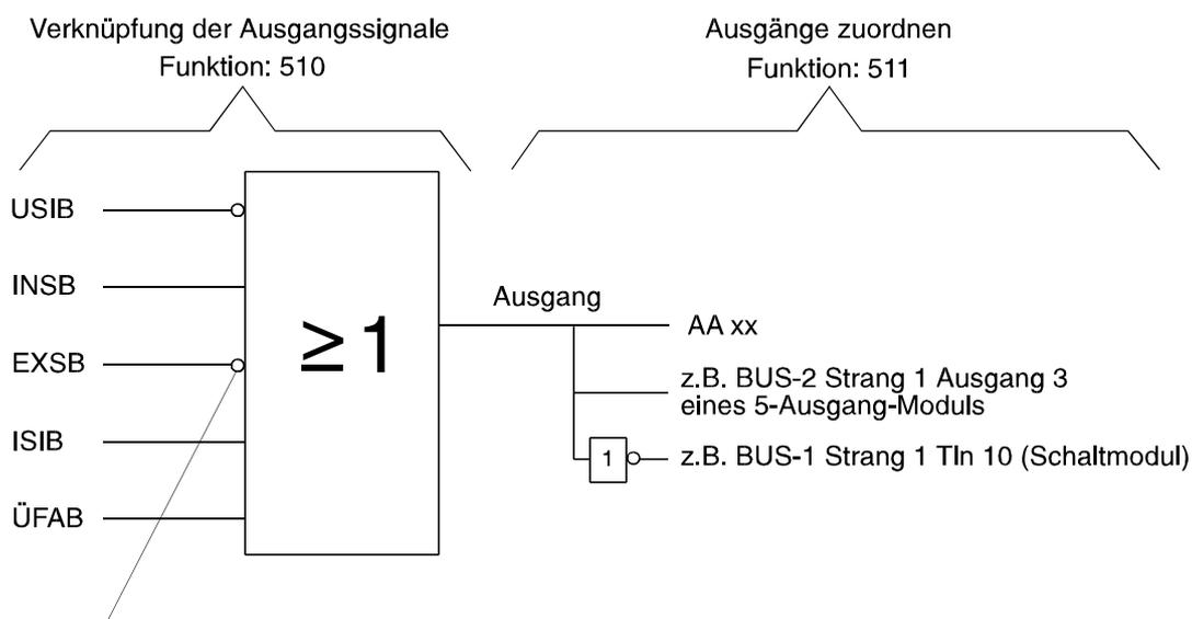
SONDER-Funktion durch invertierbares Eingangssignal
