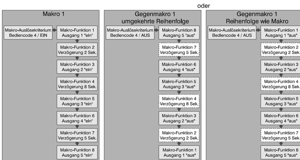
Im obigen Beispiel erfolgt die Auslösung des Makros durch Eingabe eines Bediencodes und Quittierung über Taste "EIN". Das Gegenmakro hierzu wird durch Eingabe des Bediencodes und Quittierung über "AUS" gestartet.
