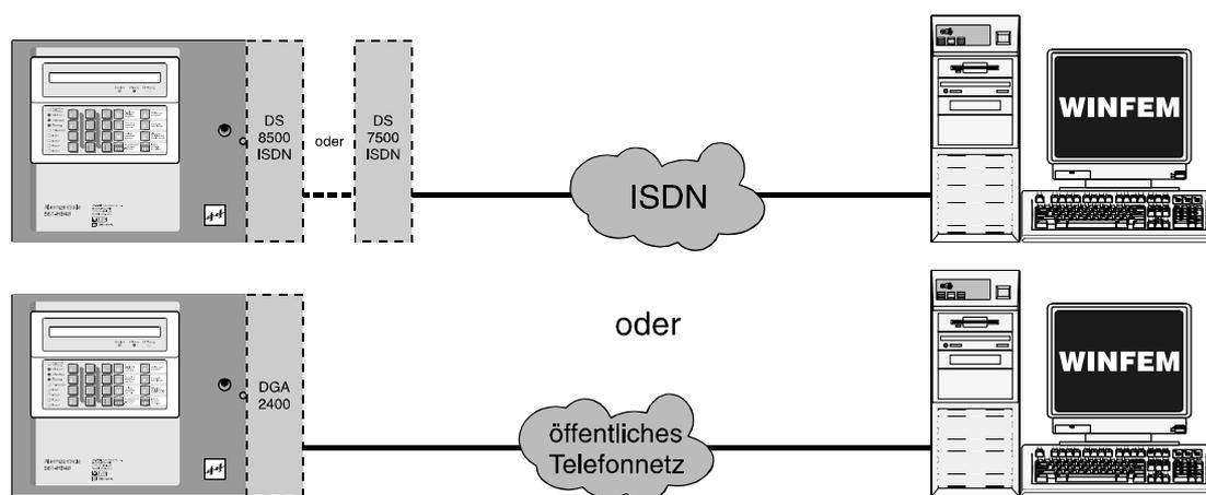
**Abb. 98** Fernparametrierung über Fernsprechnetz
