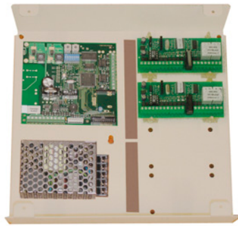
Manager M4: Netzteil 12V 2,1A ohne Akkuladeschaltung, bis 4 I/O-Module einbaubar.
