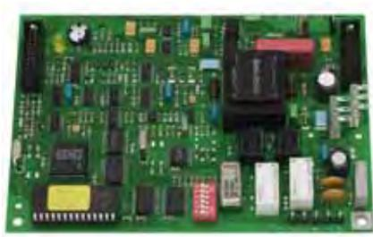
Empfangsmodul für analogen Netzzugang (analoges Fernsprechnet).
