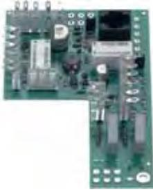
Die optional einsetzbare BMA-Anschlussplatine stellt eine Brandmeldeschchnittstelle gemäß DIN 14675, Anhang B, sowie VdS 2463 zur Verfügung und erlaubt die Übertragung von Brand- und Störmeldungen aus Brandmeldeanlagen mittels DS 7700 / DS 7600 / DS 6700 / DS 6750.
