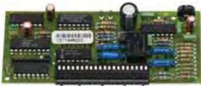
Die Karte dient in Verbindung mit dem Mikrofon 040110 zum Aufsprechen der Texte. Nur einmal erforderlich.
