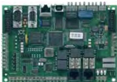
Empfangsmodul für TCP/IP Netzzugang über Ethernet.
