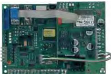
Aufsteckmodul mit GSM-Terminal, Redundanter Funkweg. GSM-/ GPRS Informationsübertragungssystem für digitale Übertragungsgeräte.
