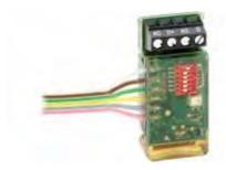
Mit dem Mini-Modul BUS-2 ist es möglich, einen Melder mit konventioneller Anschlusstechnik in ein BUS-2 System zu integrieren. Über drei Logik-Eingänge können alle notwendigen Meldungen (Alarm, Störung, Sabotage) an die Zentrale übermittelt werden.
